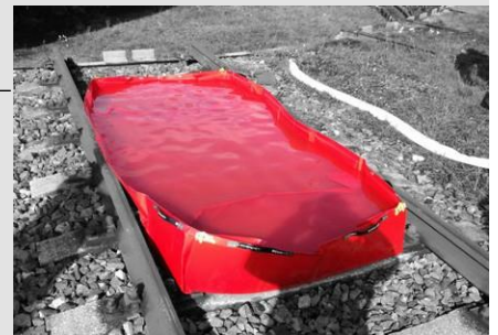
Die Wanne kann in zweierlei Weise unter den Zug oder ein anderes Schienenfahrzeug verbracht werden: quer über die Gleise oder längs in den Innenbereich zwischen den Gleisen. Beide
