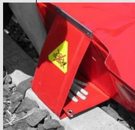
Die Wanne kann in zweierlei Weise unter den Zug oder ein anderes Schienenfahrzeug verbracht werden: quer über die Gleise oder längs in den Innenbereich zwischen den Gleisen. Beide
